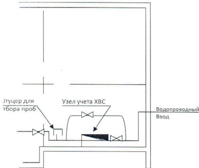
1. Схема узла учета холодной воды
